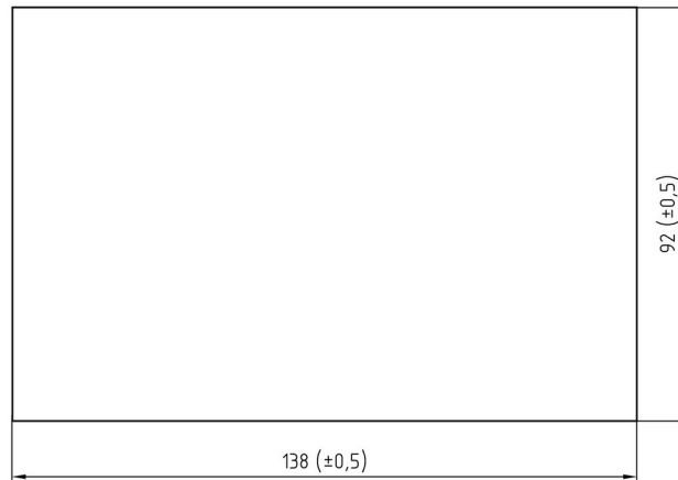
Рисунок 9 Требуемые размеры окна для установки контроллера
